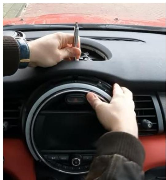
Trennen Sie alle Stecker (5 Stück). Drücken Sie mit einem kleinen Flachschaubendreher auf die Lasche des schwarzen dreipoligen Steckers. Drücken Sie den Videoanschluss auf der Rückseite des Bildschirms unten in die Palette. Hebeln Sie sehr vorsichtig mit einem kleinen flachen Gegenstand zwischen der Naht, wenn der Stecker sehr fest ist. Die restlichen Stecker können durch gleichzeitiges Drücken der Laschen herausgezogen werden.
